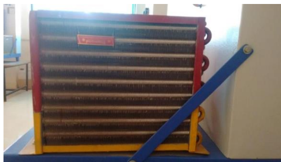
Figure. Actual air cooled fin tube condenser
