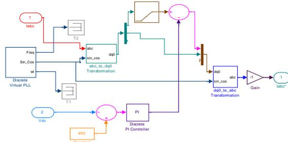
$$\begin{bmatrix} i_{Ld} \\ i_{Lq} \\ i_{L0} \end{bmatrix} = \begin{bmatrix} \cos(\omega t) & \cos(\omega t - 2\pi/3) & \cos(\omega t + 2\pi/3) \\ -\sin(\omega t) & -\sin(\omega t - 2\pi/3) & -\sin(\omega t + 2\pi/3) \\ 1/\sqrt{2} & 1/\sqrt{2} & 1/\sqrt{2} \end{bmatrix} \begin{bmatrix} i_{La} \\ i_{Lb} \\ i_{Lc} \end{bmatrix} \quad (2)$$
