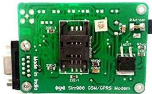
Fig. 2 GSM Module SIM900
