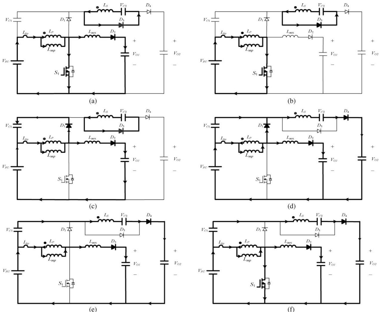
Fig. 4. Topological modes: (a) Mode 1 [ $t_0-t_1$ ]; (b) Mode 2 [ $t_1-t_2$ ]; (c) Mode 3 [ $t_2-t_3$ ]; (d) Mode 4 [ $t_3-t_4$ ]; (e) Mode 5 [ $t_4-t_5$ ]; (f) Mode 6 [ $t_5-t_6$ ].
