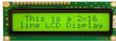
Figure6:2 x 16 LCD display
