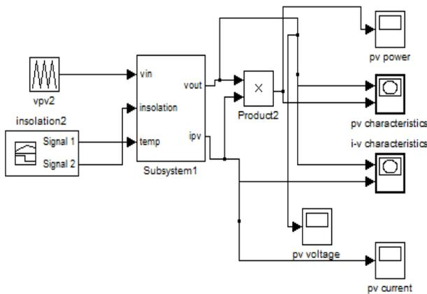
Fig. 4: Simulink model of PV module
