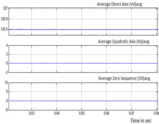
Fig.14. Output waveform of dq0-average dq0 signal.
